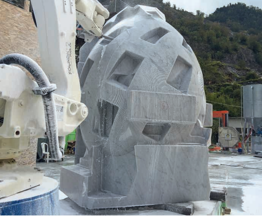
Im Steinbruch in Carrara: Ausschneiden der Fensteröffnungen mit CAD gesteuertes Fräsmaschine. (Foto: Jris Reist)
